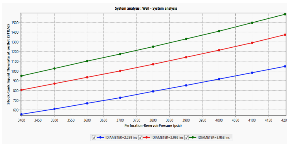
شکل ۲۲: آنالیز حساسیت فشار مخزن و تأثیر آن بر روی تولید از لوله مغزی در عمق ۲۵۰۰ متری
